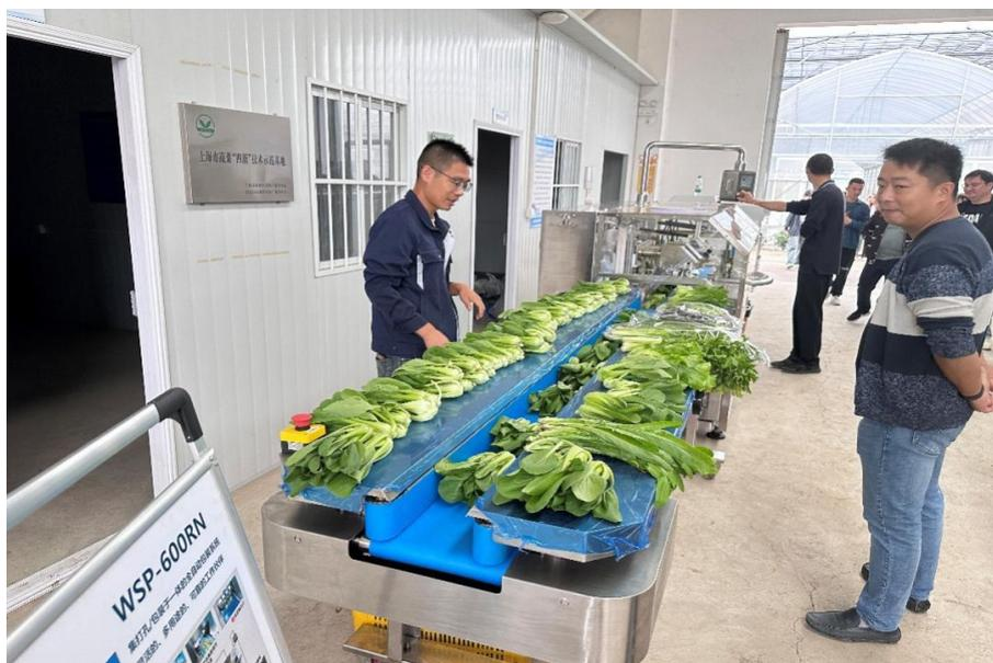
首次引进的悦玺包装机械有限公司的 WSP-600RN 全自动包装机,集打孔、包装于一体,可以自动识别产品长短、调节切刀高度,每分钟包装 30-60 袋,促进“数字+”赋能蔬菜生产全产业链建设。
